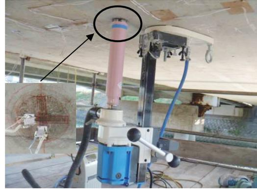
写真-1 コア切込み法による計測状況
