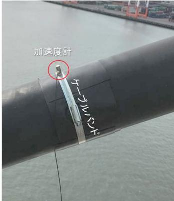
写真-1 加速度計の設置状況
