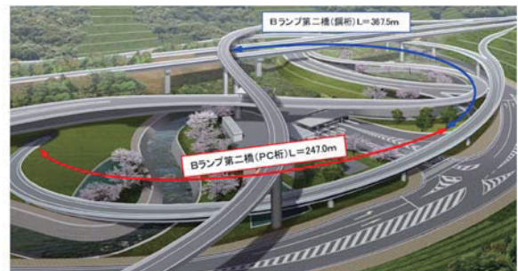
図-2 Bランプ第二橋の架橋位置
