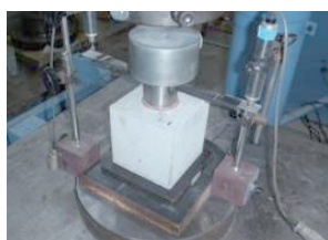
写真-2 押抜試験
