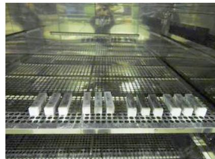
写真-2 容積基準質量含水率の試験状況
