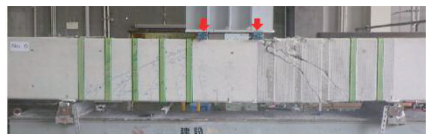
写真-7 No. 6の破壊状況
