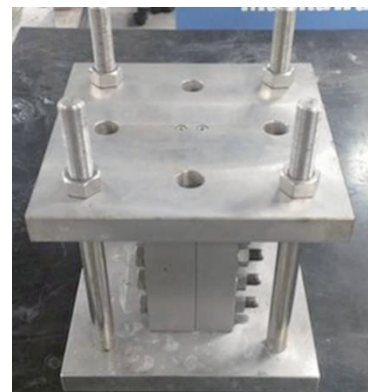
図-3 拘束した型枠
