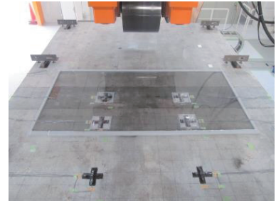
写真-3 水張り試験状況
