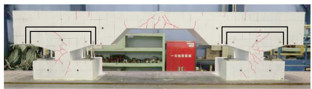
図-9 荷重終了後の試験体
