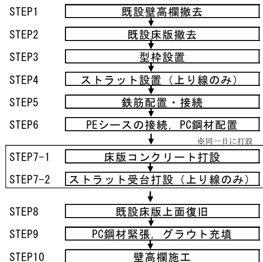
図-4 床版拡幅の施工手順
