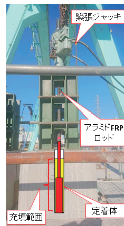
写真-2 引張試験状況
