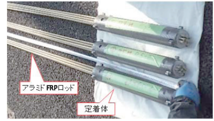
写真-1 アラミドFRPロッドと定着体
