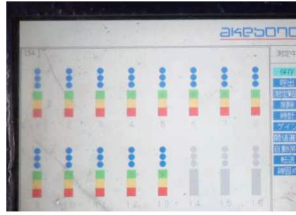
写真-5 充填締固め確認モニター
