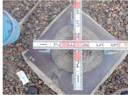
写真-1 中流動コンクリート
