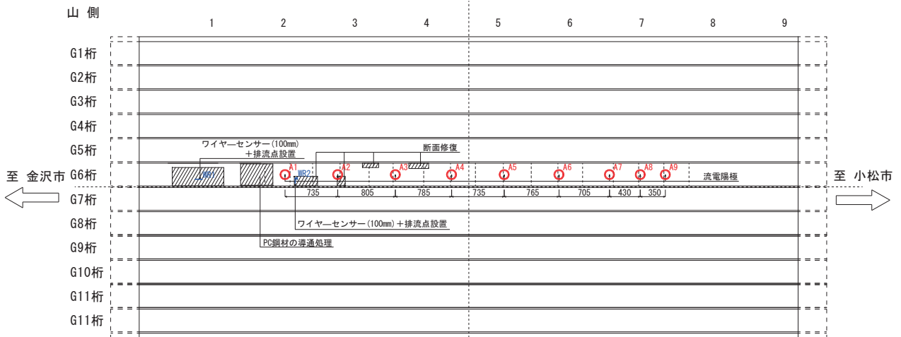
図-5 G6 桁下面の流電陽極材配置図
