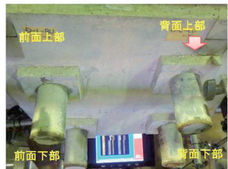
写真-2 定着装置L側の外観(783kN時点)
