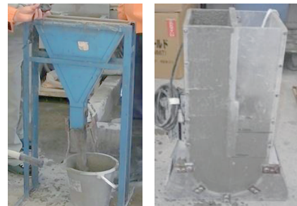
写真-1 V漏斗試験, U型充填試験
