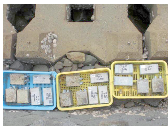
写真-2 供試体の曝露状況(干満帯)
