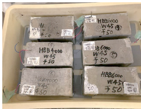
写真-1 室内促進試験
