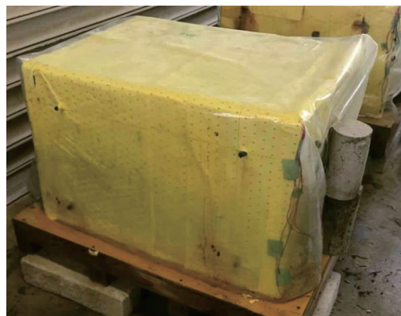
写真-1 塩化物イオン浸透状況
