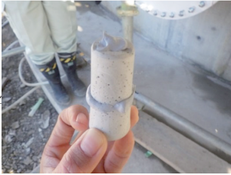
写真-3 接着剤塗布状況
