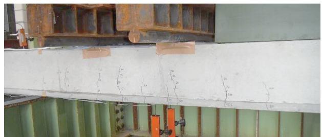
写真-4 側面のひび割れ発生状況 (供試体 2-2, 荷重荷重 100kN)
