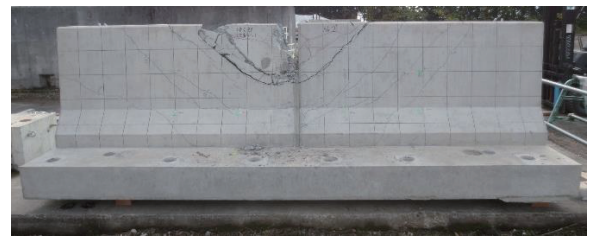
写真-2 破壊性状(試験体③, 荷重 STEP4)
