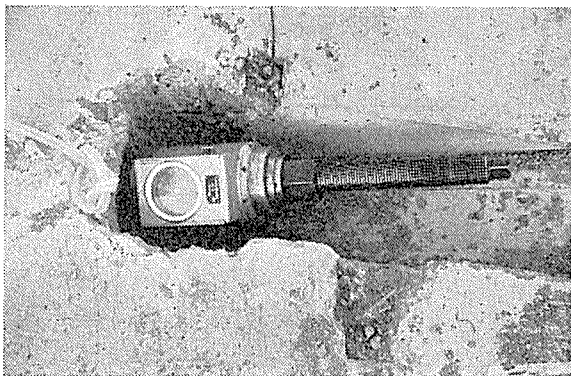
写真-6 非緊張端のダイナモメータによる鋼棒引張力測定
