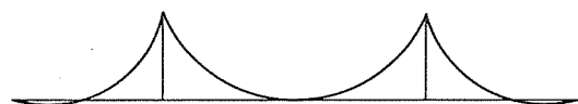
a) M_{gB} : カンティレバーとして作用している静定モーメント
