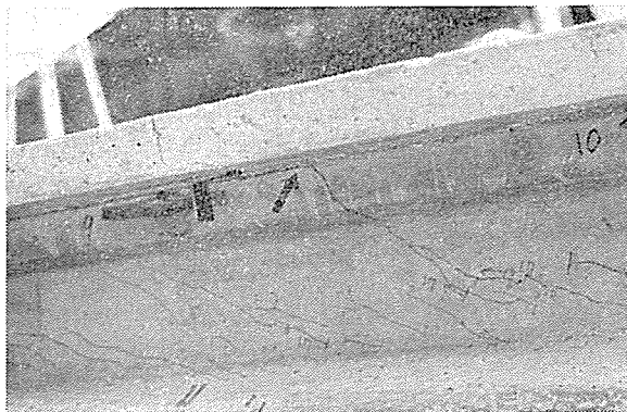
写真-3 斜引張きれつが伸びて PC 桁と床版の結合面にきれつが発生した (矢印) (合成桁-1)
