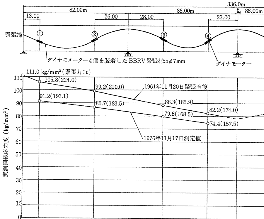
図-6.1 ダイナモメーター位置における緊張時および 15 年後の鋼線応力度 (Monbijou 橋)
