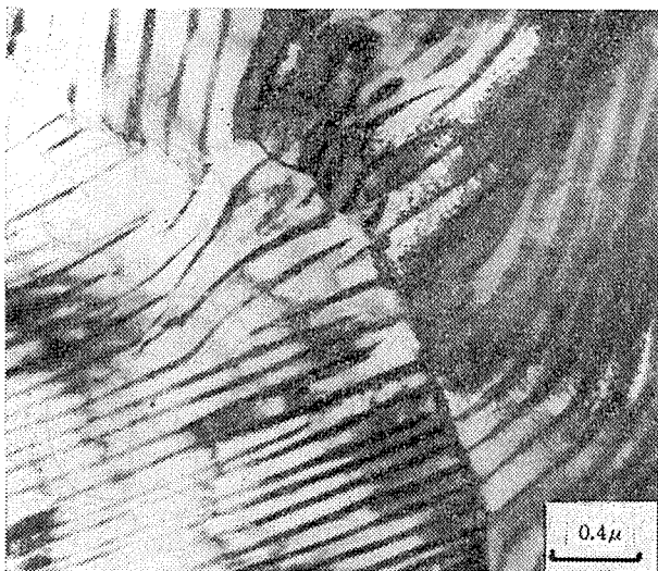
写真-1 高炭素鋼線材の鉛パテンティング組織を示す薄膜透過電子顕微鏡写真 (細い帯状のものがセメンタイト)
