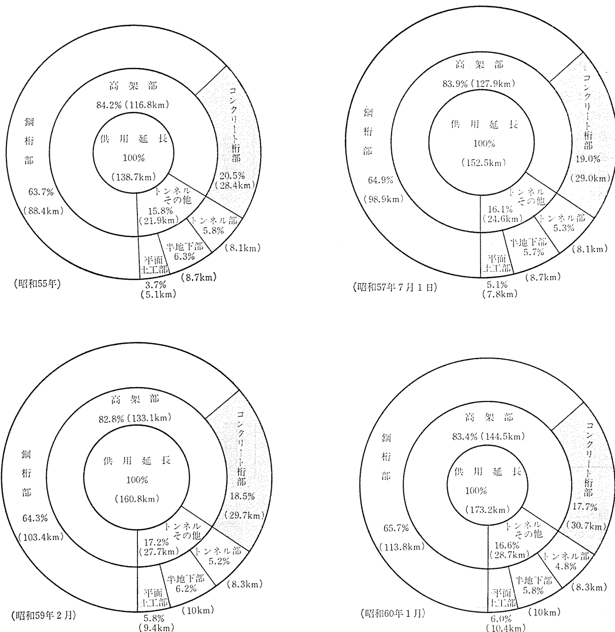
図—4 首都高速道路の構造別構成の推移 (首都高速道路公団 保全関係ポケットブックによる)
