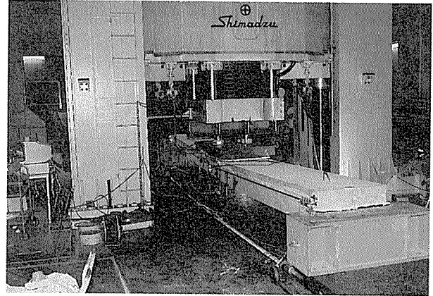
写真-4 CSTスラブ合成床の試験
