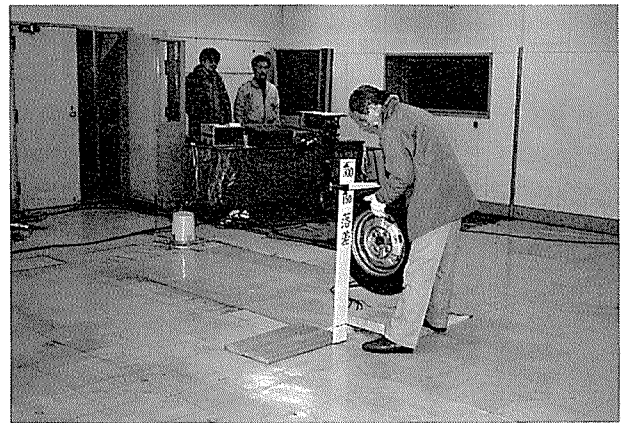
写真-7 床の振動測定 無載荷時
