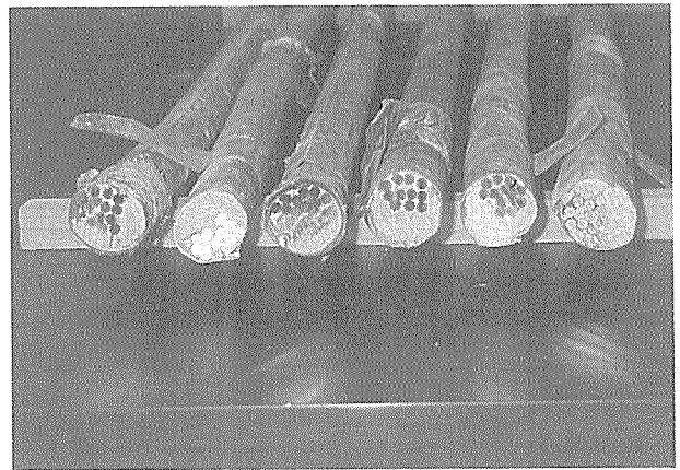
写真-3 グラウトの充填状況
