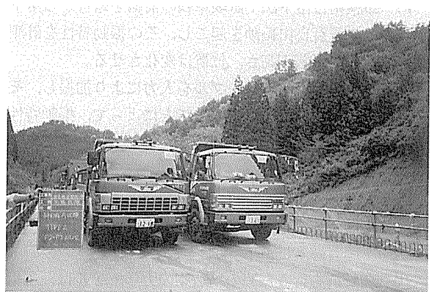
写真-8 静的荷重試験
