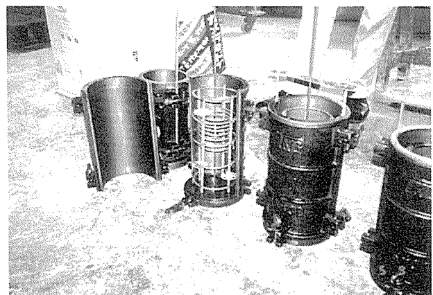
写真－4 引抜き試験体製作状況
