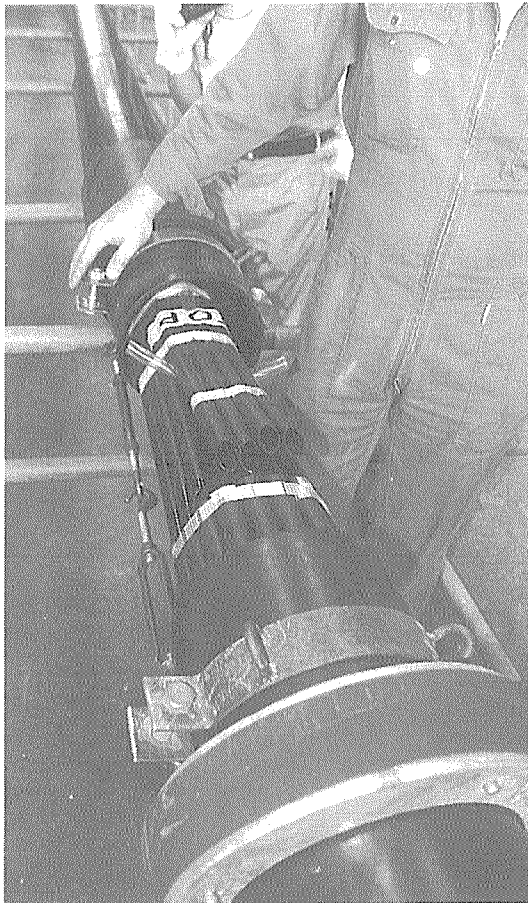
写真-2 SSIガイドチューブと外套管
