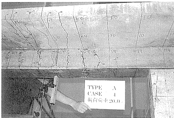
写真-4 荷重点直下の塑性ヒンジ
