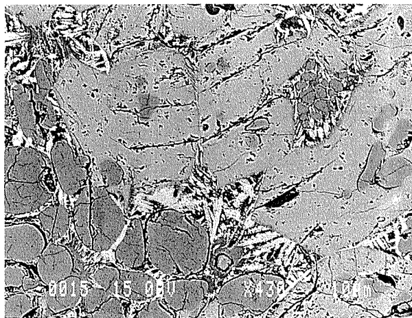
写真-4 ポルトランドセメントクリンカーの背面反射電子像
