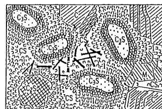
写真-5 硬化セメントペーストのSEM写真と模式図 12)
