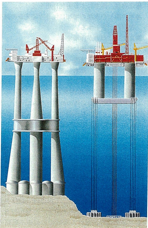
(a) Troll プラットフォーム (設置水深：300m) (b) Heidrun TLP (設置水深：350m)
