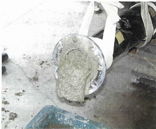
写真-4 試験1での変形管出口付近の圧送状況
