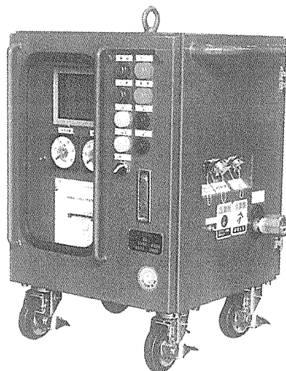
写真-6 グラウト流量計
