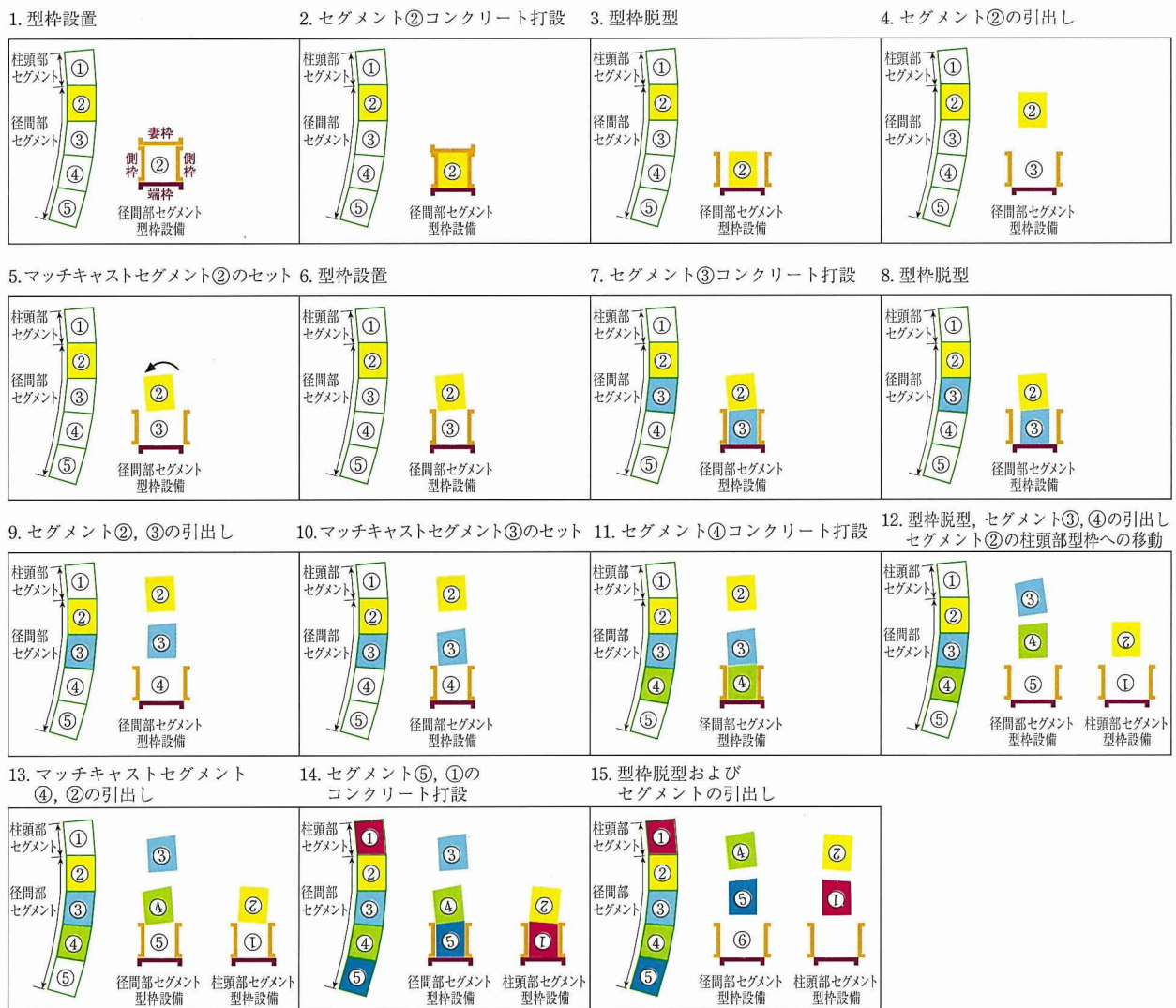
図 - 5 セグメント移動と型枠位置関係 (平面図)
