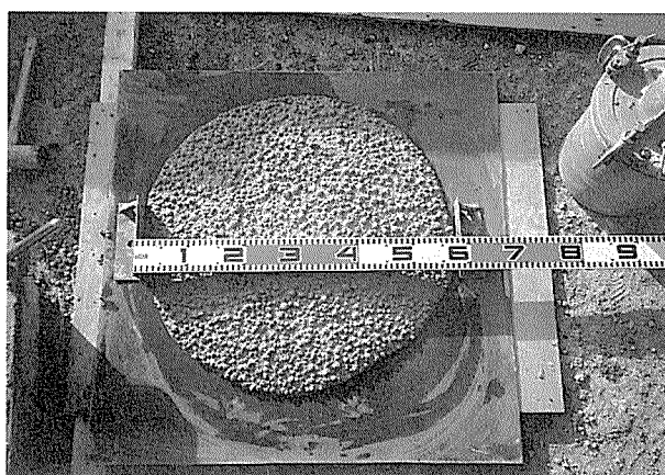
写真 - 3 スランプフロー管理状況
