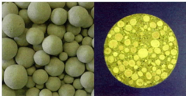
写真 - 2 高性能軽量骨材と高性能軽量骨材コンクリート
