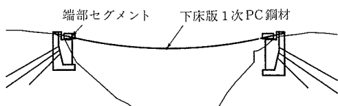
Step 2 下床版セグメントの懸垂架設
