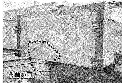
写真-1 PC鋼棒突出防止状況(供試体No.4)
