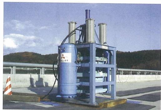
写真 - 1 鉛直方向加振
