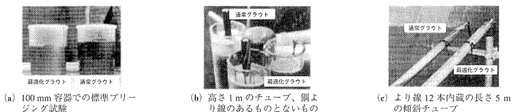
図 - 3 さまざまな種類の試験体におけるブリージングと体積変化
