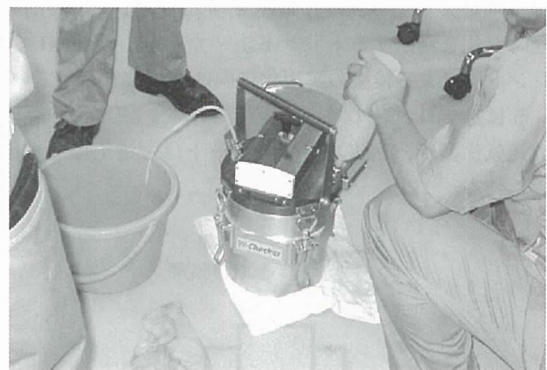
水量が変化すると単位容積質量が変化することを利用し測定
