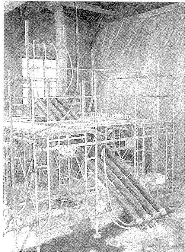
図 - 12 傾斜管試験
