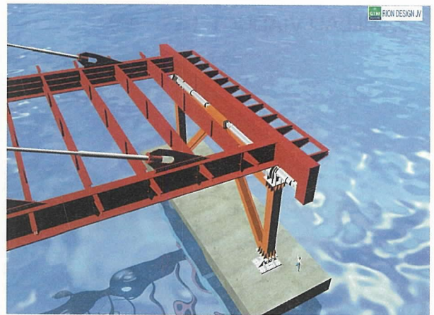
図-7 主桁端部の構造
