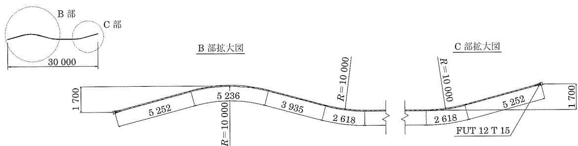
本試験—12 S 15.2 / 長さ 150 m / 最大角度 15 度 / 高低差 1.7 m / 曲げ半径 10.0 m
