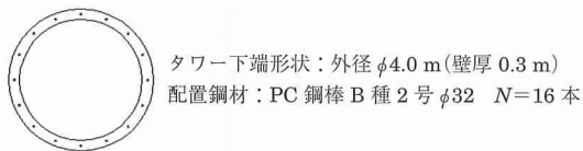
図-5 タワー下端断面の配置PC鋼材
