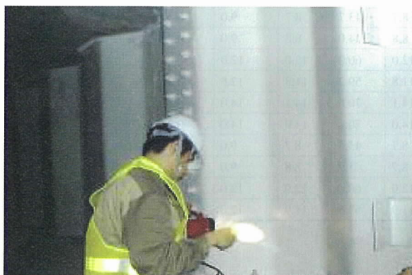
(a) 塗膜厚の測定状況
