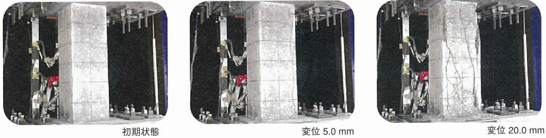
図 - 6 柱の交番載荷実験
